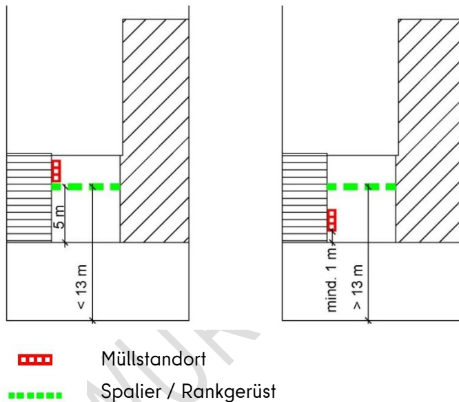
Abbildung 10 Müllstandorte im Übergangsbereich
